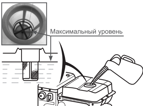
Рис. 8 Максимальный уровень топлива в топливном баке
